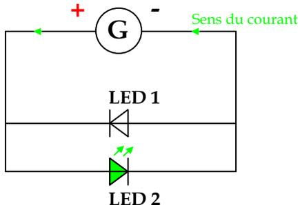
Dans le montage ci-contre, le courant imposé par le **générateur de tension continue** passé dans un seul sens : du + vers le - à l'extérieur de ce générateur.
