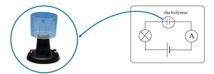
O Compléter le tableau ci-dessous en versant successivement les différentes solutions dans l'électrolyseur en prenant soin de <u>rincer la cuve de l'électrolyseur avec de l'eau pure entre chaque manipulation.</u>
